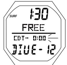
Fig. 149 - ALLARME CONTO ALLA ROVESCIA SUPERFICIE
