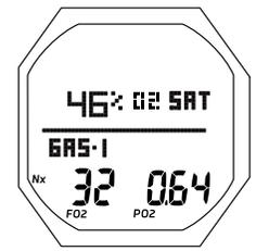
Fig. 66 - IN CURVA ALT 3 (% di saturazione di O2)
