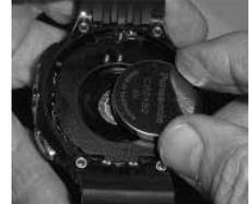
Fig. 182 - INSTALLAZIONE DELLA BATTERIA
