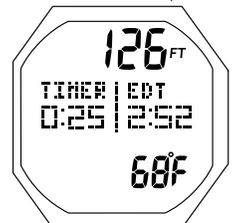
Fig. 147B - IMMERSIONE TECH FREE PRINCIPALE (contatore di esercizio in uso)
