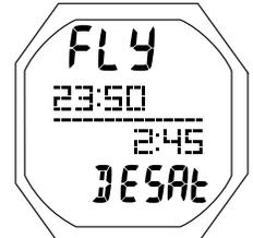
Fig. 22 - FLY/DESAT (10 min dopo l'immersione)
