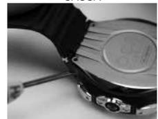
Fig. 179A - PER ALLENARE IL COPERCHIO DELLA BATTERIA
