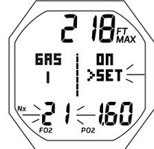
Fig. 30B - IMPOSTAZIONE GAS 1 (per impostare FO2 e allarme PO2)
