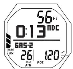
Fig. 91 - AVVISO PO2 (in curva, durante l'intervento dell'allarme acustico)
