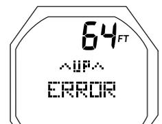
Fig. 69 - ERRORE (durante l'immersione)
