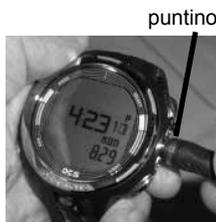
Fig. 175 - CAVO DI INTERFACCIA PC (inserirlo posizionando il puntino a ore 12) puntino
