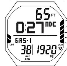
Fig. 64B - IMMERSIONE NORM (velocità di risalita eccessiva)
