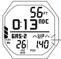
Fig. 92 - ALLARME PO2 (in curva, dopo l'intervento dell'allarme acustico)
