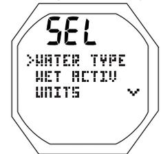
Fig. 141 - MENU IMPOSTAZIONE UTILITÀ (per accedere a Impostazione tipo acqua)
