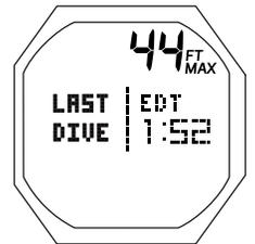
Fig. 115 - SURF ALT 1 (dati relativi all'ultima immersione)
