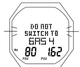
Fig. 101 - ALLARME CAMBIO MISCELA
