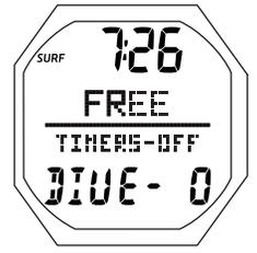
Fig. 114A - FREE SURF PRINCIPALE (nessuna immersione ancora effettuata, cronometri OFF)
