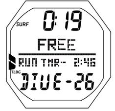
Fig. 114B - FREE SURF PRINCIPALE (post-immersione, cronometro in funzione)
