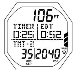
Fig. 108B - IMMERSIONE GAUG PRINCIPALE (cronometro impostato su ON)
