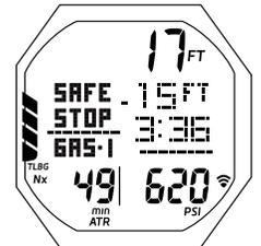
Fig. 78A - SOSTA DI SICUREZZA PRINCIPALE (profondità/tempo di sosta impostati)
