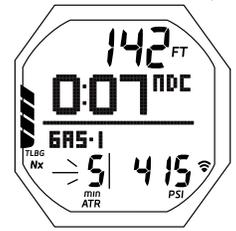
Fig. 68 - IN CURVA PRINCIPALE (in fase di Allarme ATR)
