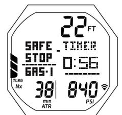
Fig. 79 - SOSTA DI SICUREZZA PRINCIPALE (impostata per uso cronometro)
