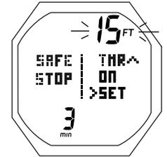
Fig. 46B - IMPOSTAZIONE SOSTA DI SICUREZZA (tempo e profondità)
