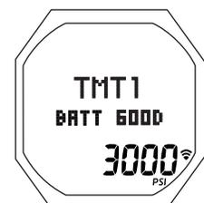
Fig. 60 - STATO BATTERIA TMT
