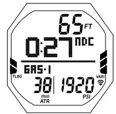
Fig. 67 - IN CURVA PRINCIPALE (38 min di autonomia aria rimanenti)
