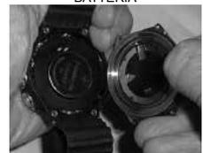
Fig. 179B - ESTRAZIONE DEL COPERCHIO DELLA BATTERIA
