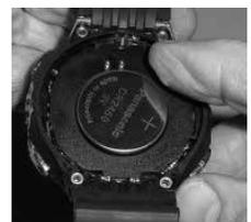
Fig. 180 - RIMOZIONE DELLA BATTERIA
