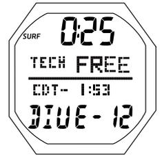
Fig. 114C - TECH FREE SURF PRINCIPALE (post-immersione, conto alla rovescia in funzione)
