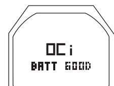
Fig. 59 - STATO BATTERIA OCi
