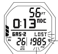
Fig. 62 - PERDITA DI COLLEGAMENTO
