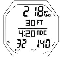
Fig. 24A - PDPS (controllo azoto)
