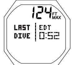
Fig. 18 - NORM SURF ALT 1 (dati relativi all'ultima immersione)
