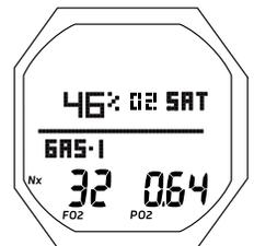
Abb. 66 - NULLZEIT ALT 3 (% der O<sub>2</sub>-Sättigung)
