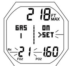
Abb. 30B - EINSTELLUNG GAS 1 (zum Einstellen des FO2 dann PO2 Alarm)
