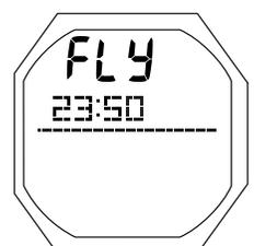
Abb. 106 - GAUG FLY (10 Min. nach Tauchgang)
