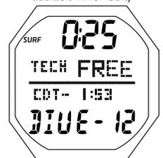
Abb. 114C - TECH FREE SURF HAUPT (nach dem Tauchgang, CDT läuft)
