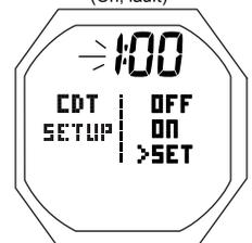
Abb. 6C - EINSTELLUNG CDT (Stunden dann Minuten)
