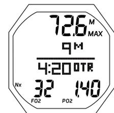
Abb. 24B - PDPS (Sauerstoffkontrolle)
