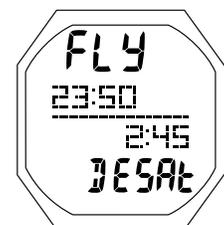
Abb. 22 - FLY/DESAT (10 Min. nach Tauchgang)
