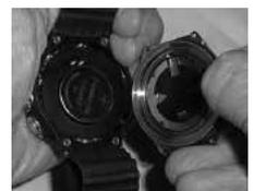
Abb. 179B - ABHEBEN DES BATTERIEDECKELS
