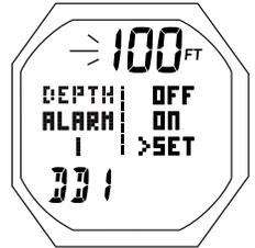
Abb. 137 - EINSTELLUNG DD ALARM
