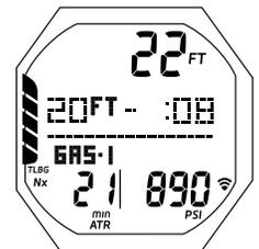
Abb. 63B - NORM TAUCHGANG (TLBG wenn in Deko)
