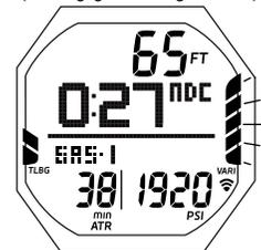
Abb. 64B - NORM TAUCHGANG (wenn Aufstiegs geschwindigkeit zu schnell)
