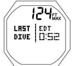
Abb. 18 - NORM SURF ALT 1 (Datum letzter Tauchgang)
