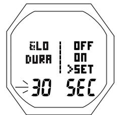
Abb. 49 - EINSTELLUNG DISPLAYBELEUCHTUNGSDAUER
