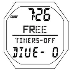
Abb. 114A - FREE SURF HAUPT (noch kein Tauchgang, Timers OFF)
