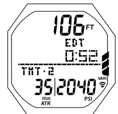
Abb. 64A - GAUG TAUCHGANG (Aufstiegs geschwindigkeit ist ok)
