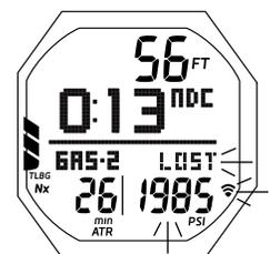
Abb. 62 - VERBINDUNG UNTERBROCHEN
