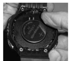
Abb. 180 - BATTERIE ENTFERNEN
