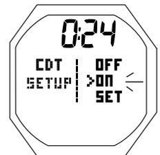
Abb. 6B - EINTRICHTUNG CDT (On, läuft)
