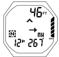
Fig. 65A - ÉCRAN PRINCIPAL DE PLONGÉE SANS DÉCOMPRESSION (le temps de plongée restant sans décompression est le temps de plongée restant)
