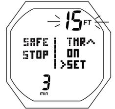
Fig. 46B - RÉGLAGE D'UN PALIER DE SÉCURITÉ (temps puis profondeur)
