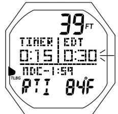
Fig. 152 - ALARME RÉPÉTITIVE D'INTERVALLE DE TEMPS EN PLONGÉE
