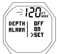
Fig. 35 - RÉGLAGE DE L'ALARME DE PROFONDEUR
