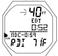
Fig. 153 - ALARME RÉPÉTITIVE D'INTERVALLE DE PROFONDEUR EN PLONGÉE
