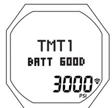
Fig. 60 - ÉTAT DE LA PILE DE L'ÉMETTEUR
