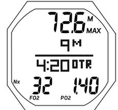
Fig. 24B - SÉQUENCE DE PLANIFICATION PRÉ-PLONGÉE (plongée contrôlée par l'oxygène)
