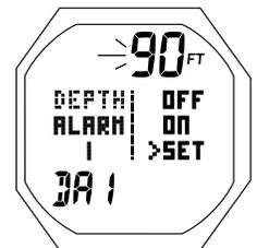
Fig. 139A - RÉGLAGE DE L'ALARME DE PROFONDEUR DE DESCENTE/REMONTÉE
