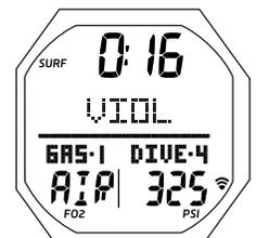
Fig. 90B - ÉCRAN PRINCIPAL SURFACE D'INFRACTION AVEC LIMITATION AU MODE PROFONDIMÈTRE (après que 10 minutes se soient écoulées)
