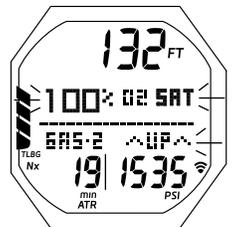
Fig. 95 - ALARME O2 (sans décompression, Décompression identique)
