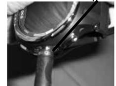
Fig. 176 - CÂBLE D'INTERFACE PC (tournez pour positionner le repère à 1 h)
