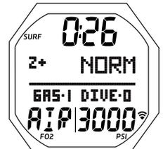
Fig. 17A - ÉCRAN PRINCIPAL SURFACE NORM (aucune plongée effectuée jusque-là)
