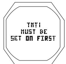
Fig. 53 - MESSAGE LORS DU RÉGLAGE D'UN ÉMETTEUR (essai d'activation de l'émetteur 2 alors que l'émetteur 1 est réglé sur OFF)
