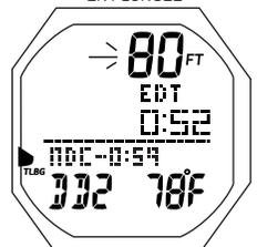
Fig. 154 - ALARME DE PROFONDEUR DE DESCENTE FREE
