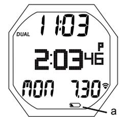
Fig. 1A - MISE EN GARDE DE PILE FAIBLE (heure principale de la montre)
