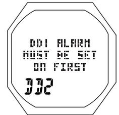
Fig. 138 - MESSAGE RELATIF AU RÉGLAGE DE L'ALARME DE PROFONDEUR DE DESCENTE
