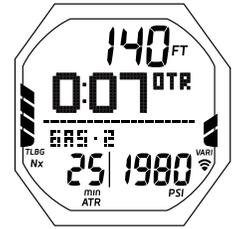
Fig. 65B - ÉCRAN PRINCIPAL DE PLONGÉE SANS DÉCOMPRESSION (le temps d'oxygène restant est le temps de plongée restant)
