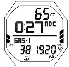
Fig. 67 - ÉCRAN PRINCIPAL DE PLONGÉE SANS DÉCOMPRESSION (36 min de temps d'air restant)
