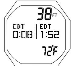
Fig. 147A - ÉCRAN PRINCIPAL PLONGÉE TECH FREE (minuteur de compte à rebours en service)
