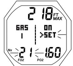
Fig. 30B - RÉGLAGE DU MÉLANGE GAZEUX 1 (pour définir le FO2 et l'alarme PO2)
