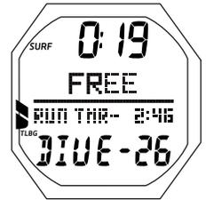
Fig. 114B - ÉCRAN PRINCIPAL SURFACE FREE (post-plongée, minuteur en fonction)
