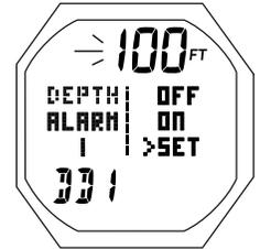
Fig. 137 - RÉGLAGE DE L'ALARME DE PROFONDEUR DE DESCENTE
