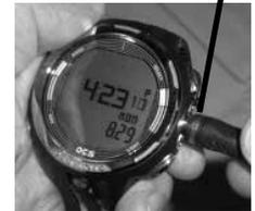
Fig. 175 - CÂBLE D'INTERFACE PC (insérez le câble en positionnant le repère à midi)
