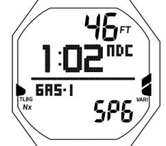
Fig. 71B - ÉCRAN PRINCIPAL DE PLONGÉE SANS DÉCOMPRESSION (aucun émetteur en service)
