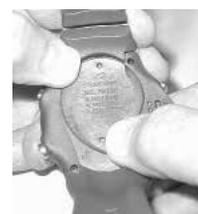
Fig. 70B - REMOCIÓN CUBIERTA BATERÍA (sin herramienta)
