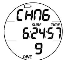
Fig. 3 - ALARMA BATERÍA BAJA
