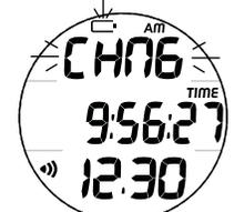
Fig. 60 - ALARMA BATERÍA BAJA DEL RELOJ
