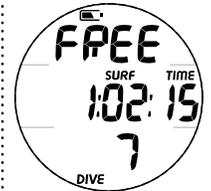
Fig. 63 - ADVERTENCIA DE BATERÍA BAJA DEN MODO FREE EN SUPERFICIE
