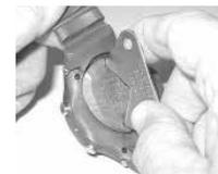
Fig. 80 - INSTALACIÓN CUBIERTA BATERÍA (con herramienta)
