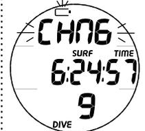
Fig. 64 - ALARMA DE BATERÍA BAJA EN MODO FREE EN SUPERFICIE
