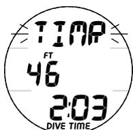
Fig. 65 - ALLARME CONTO ALLA ROVESCIA IMMERSIONE FREE
