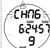
Fig. 64 - ALLARME BATTERIA SCARICA SUPERFICIE FREE
