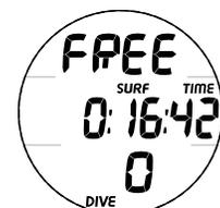
Fig. 21A - SURF PRINCIPALE (nessuna immersione ancora effettuata)
