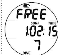
Fig. 63 - AVVISO BATTERIA SCARICA SUPERFICIE FREE
