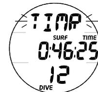
Fig. 61 - ALLARME CONTO ALLA ROVESCIA SUPERFICIE FREE
