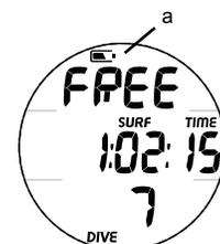
Fig. 2 - AVVISO BATTERIA SCARICA
