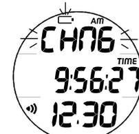
Fig. 60 - ALLARME BATTERIA SCARICA OROLOGIO
