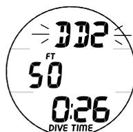
Fig. 68 - ALLARME PROFONDITÀ IMMERSIONE FREE
