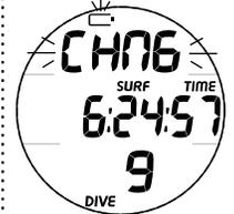
Abb. 64 - FREE OBERFLÄCHE ALARM SCHWACHE BATTERIE
