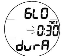
Abb. 37 - EINSTELLUNG DISPLAYBELEUCHTUNGSDAUER
