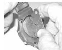
Fig. 74A - MISE EN PLACE DU COUVERCLE (à l'aide d'un outil)
