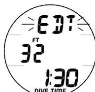
Fig. 66 - PLONGÉE FREE ALARME DE TEMPS DE PLONGÉE ÉCOULÉE
