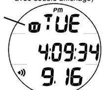
Fig. 4C - HEURE PAR DÉFAUT (secondaire sélectionnée, pas de double affichage)
