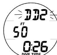
Fig. 68 - PLONGÉE FREE ALARME DE PROFONDEUR
