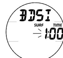
Fig. 39 - RÉGLAGE DE L'INTERVALLE DE SURFACE ENTRE LES PLONGÉES
