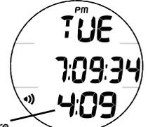
Fig. 4B - HEURE PAR DÉFAUT (principale sélectionnée, avec double affichage)
