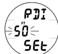
Fig. 31 - RÉGLAGE DE L'ALARME RÉPÉTITIVE D'INTERVALLE DE PROFONDEUR
