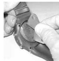
Fig. 70A - RETRAIT DU COUVERCLE DE LA PILE (avec outil)
