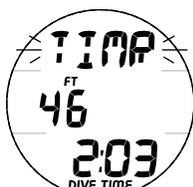
Fig. 65 - PLONGÉE FREE ALARME DU MINUTEUR DE COMPTE À REBOURS
