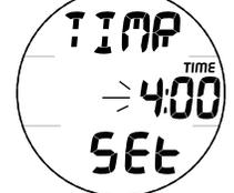
Fig. 26 - RÉGLAGE DU MINUTEUR DE COMPTE À REBOURS
