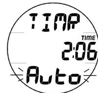
Fig. 55B - ÉCRAN SECONDAIRE DU MODE PLONGÉE (CDT réglé sur Auto)
