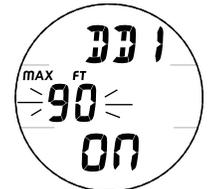
Fig. 32 - RÉGLAGE DE L'ALARME DE PROFONDEUR DE DESCENTE
