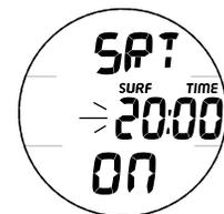
Fig. 29 - RÉGLAGE DE L'ALARME DE TEMPS DE RÉCUPÉRATION EN SURFACE
